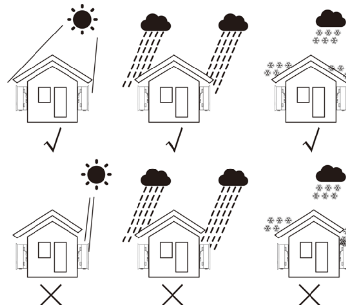
▲ Rysunek 4.1 Zalecane położenie instalacji
