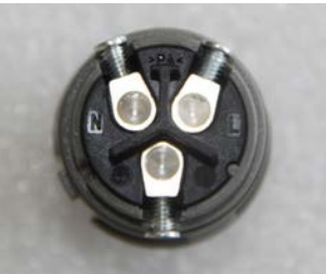
▲ Rysunek 4.13 Złącze zaciskowe sieci AC (wewnątrz)
