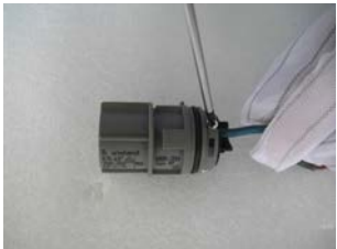
▲ Rysunek 4.16 Podłączenie przewodów do zacisku
